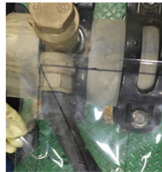
図 7-28 耐震試験後の供試品 2 (約 35° 強制屈曲)
