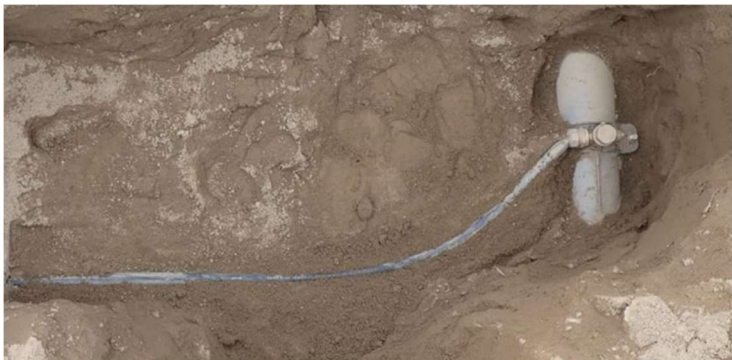
図 7-7 サドル付分水栓及び給水管の変形状況
