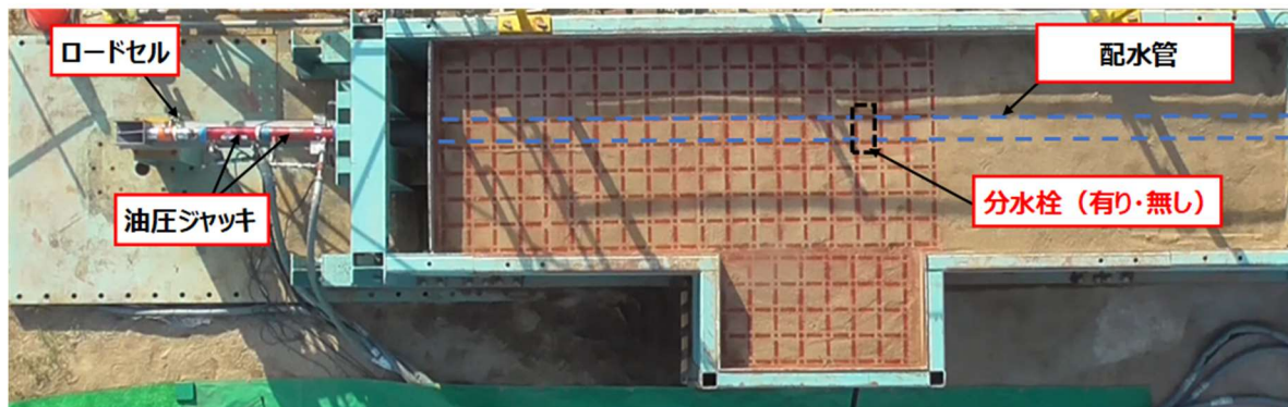
図 8-1 耐震試験装置
