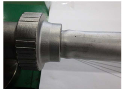
図 資 3-1 繰り返し試験（往復）10 往復後の SUS 管の状態
