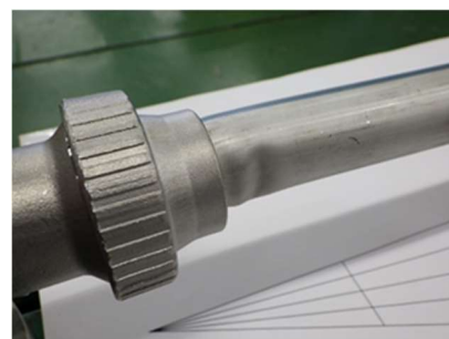
図 資 2-1 繰り返し試験（片側）10 回後の SUS 管の状態
