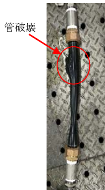
水圧試験例 (管破壊)
