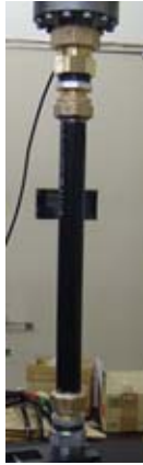
伸縮性能試験例
