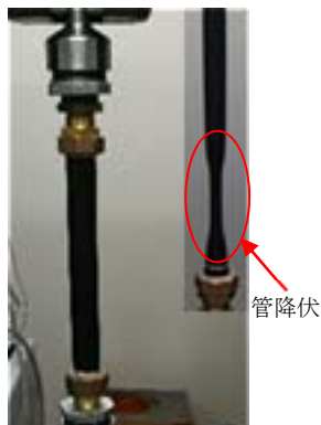
離脱防止性能試験例 (設置及び管降伏状態)
