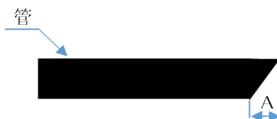
図. 管切断作業時の斜め切断状態
