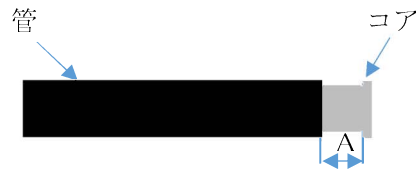
図. コアの打ち込み状態
