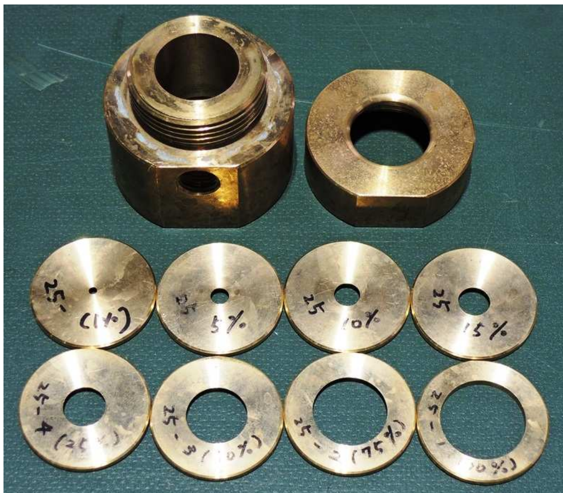
立管上端部継手と 1~100%の各開口プレートの一例 (口径 25)
