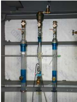
立管頂部：25 吸排気弁(840L/min 固定)
