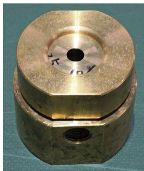
立管上端部継手に開口プレートを装着した状態の一例 (口径 25、10%)
